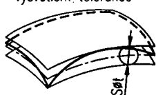
Obrázek č. 7.8, Tolerance tvaru plochy
